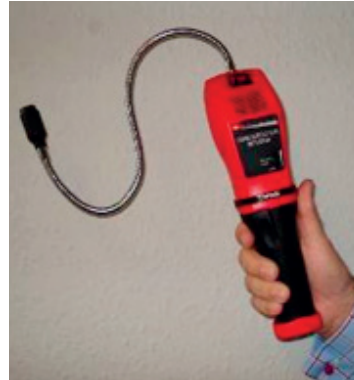
Figura 3 - Detectores electrónicos adecuados para refrigerantes inflamables
