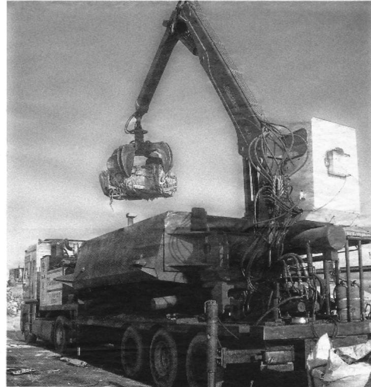
Maquinaria para el prensado de vehículos en Desguaces Monteagudo. DM
